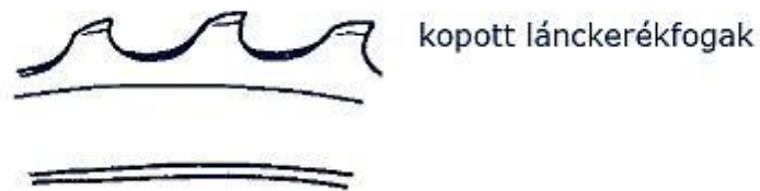
A kopott lánckerék "cápa fogai"...
