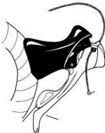
A váltóbowden befűzése Shimano, illetve Campagnolo rendszerű országúti fékváltókarba...
